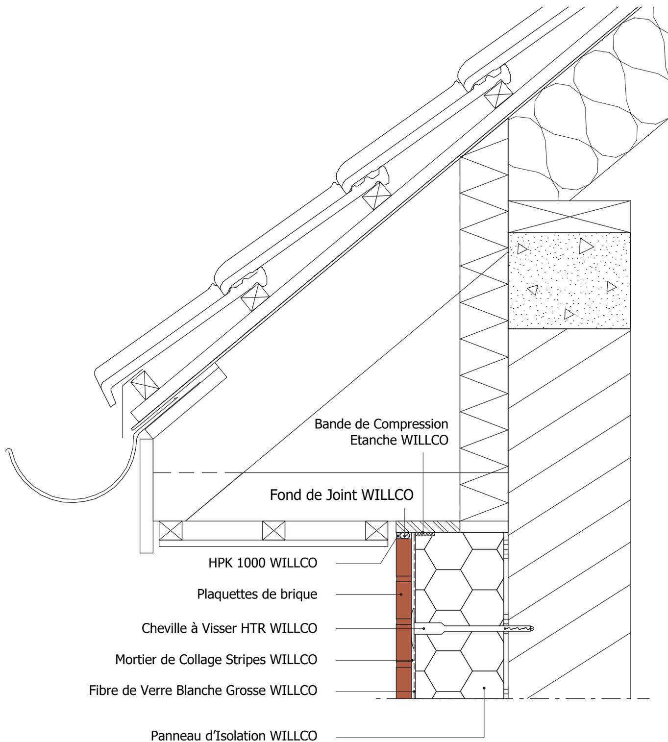
Ce détail de principe est une représentation schématique d'un système d'isolation de façade extérieure. Les raccords avec des matériaux étrangers sont eux aussi représentés de manière schématique. La situation réelle peut différer de cette représentation. Ce schéma de principe détaillé sert de fil conducteur mais doit être éventuellement adapté par l'installateur en tenant compte avec la situation réelle.
