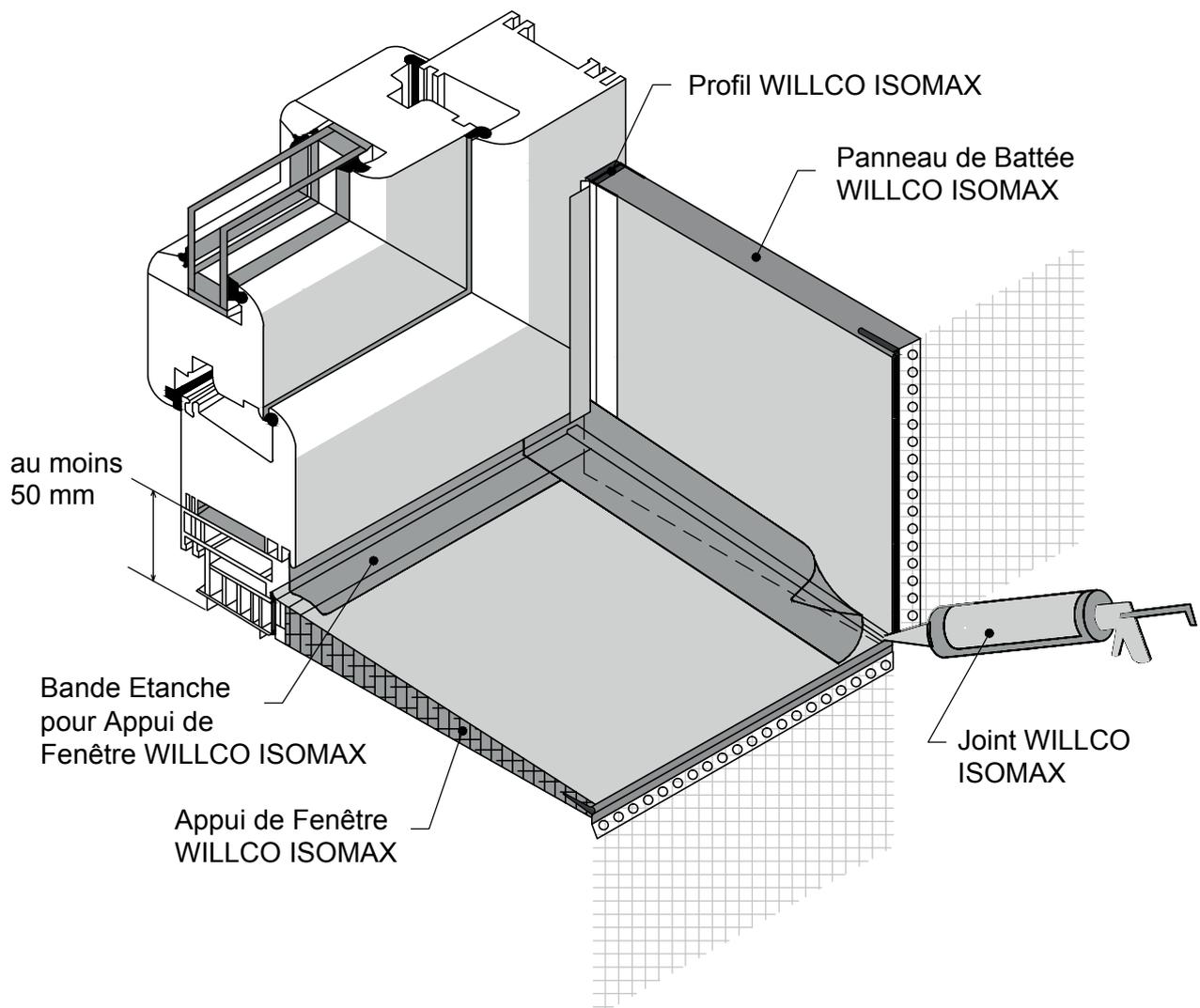
Ce détail de principe est une représentation schématique d'un système d'isolation de façade extérieure. Les raccords avec des matériaux étrangers sont eux aussi représentés de manière schématique. La situation réelle peut différer de cette représentation. Ce schéma de principe détaillé sert de fil conducteur mais doit être éventuellement adapté par l'installateur en tenant compte avec la situation réelle.
