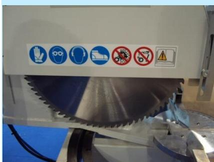
Quand le groupe de sciage se bouge vers la pièce, le capot de protection s'ouvre et la lame est libérée pour couper.
