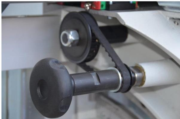
L'inclinaison de la lame peut être réglée précisément au moyen d'une courroie dentelée et cette poignée. La lame s'incline 1 degré par quart de tour.
