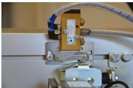
Après la découpe, ce capot de protection à deux niveaux ferme le cylindre pneumatique et protégera complètement la lame.
