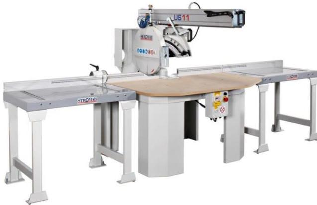
Il y a disponibles des convoyeurs en option, qui peuvent être installés tant au côté droite que gauche de la machine. Ces convoyeurs modulaires ont une longueur de base de 1 mètre. Ainsi, on peut installer les convoyeurs d'entrée et de sortie sur votre mesure préférée.
