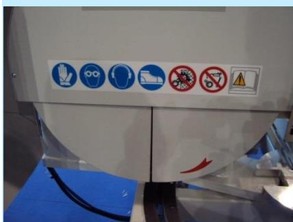
Le capot de protection à deux niveaux ferme le cylindre pneumatique après la découpe.
