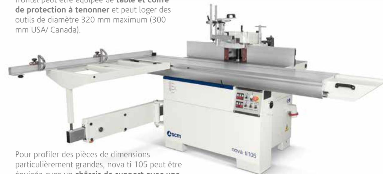
Pour profiler des pièces de dimensions particulièrement grandes, nova ti 105 peut être équipée avec un **châssis de support avec une règle à 2 butées réversibles**.
