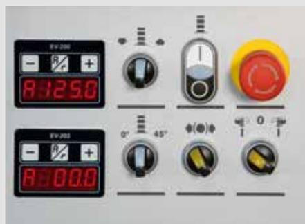
Grâce au contrôle « Easy » il est possible de gérer aisément même l'inverseur pour le réglage de la vitesse de rotation de l'arbre toupie (option).
