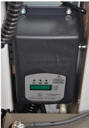
Le chargeur interne (avec prise 220V monophasée) vous permet de charger les deux batteries à tractions facilement et partout.
