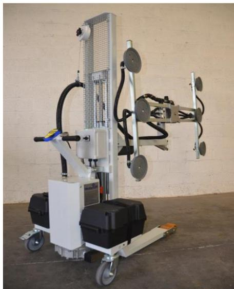
Ce système de levage permet le soulèvement et l'accrochement d'un panneau dans le sens horizontal et vertical.
