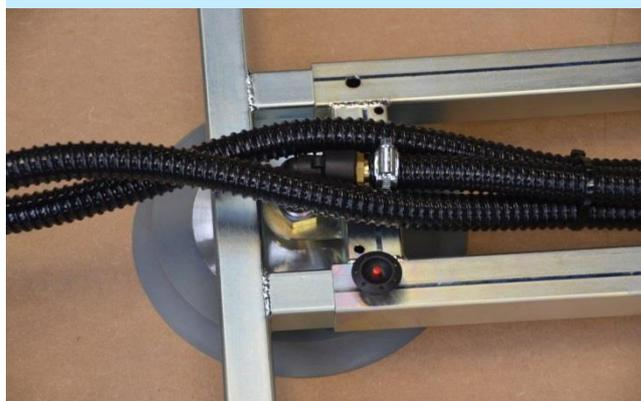
L'extension télescopique des ventouses gauches et droites permet l'adaptation aux mesures des panneaux à soulever.
