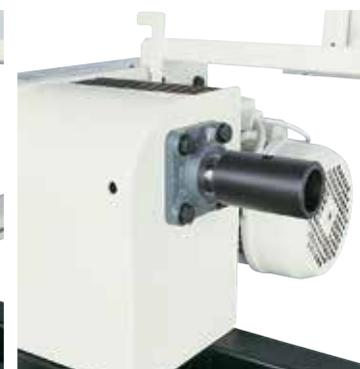
**Dispositifs d'Entraînement pour pièces en forme de coupe** diamètre 40 mm et vis de diamètre 70 mm réalisés en acier monobloc indispensables pour l'usinage de petites pièces en forme.
