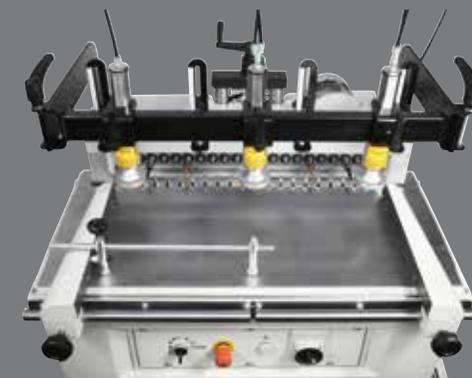
Toutes les commandes, comme l'interrupteur pour incliner de 45° la tête de perçage qui rend immédiat le passage d'une phase à l'autre, sont placées sur le devant de la machine, de manière ergonomique. Pour un perçage impeccable y compris de panneaux de grandes dimensions, la machine est équipée d'un guide latéral de 3000 mm de long, millimétré et muni de butées courbes, facile à installer et à désinstaller.
