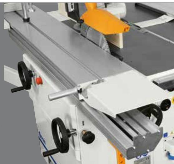
Coupes à la scie plus précises et faciles grâce à un appui parfaitement stable garanti, y compris pour les pièces de grandes dimensions, avec un **chariot coulissant de 270 mm de large.**
