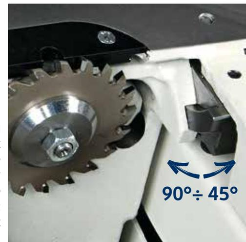
L'inciseur est réglable de l'extérieur, sans besoin de clés, assurant ainsi un positionnement rapide et précis sans jeux.
