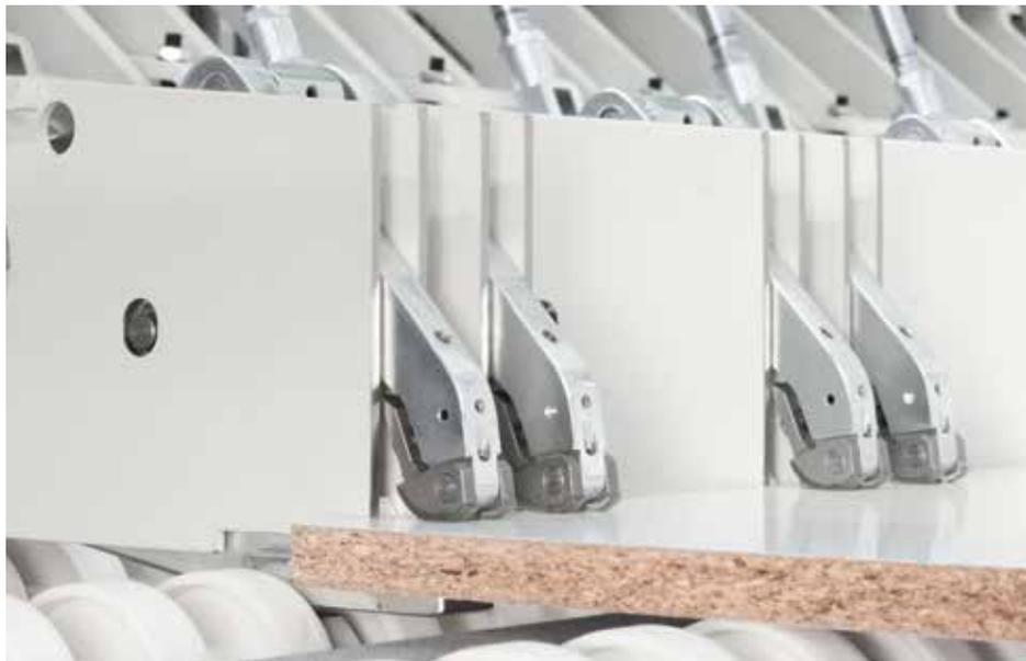
L'extrême flexibilité du dispositif est garantie également par la présence des pinces du pousseur principal qui peuvent être exclues de la zone d'usinage, permettant le blocage des bandes de différente largeur et par conséquent l'exécution de n'importe quel type de coupe différenciée sans limitation en termes de course.
