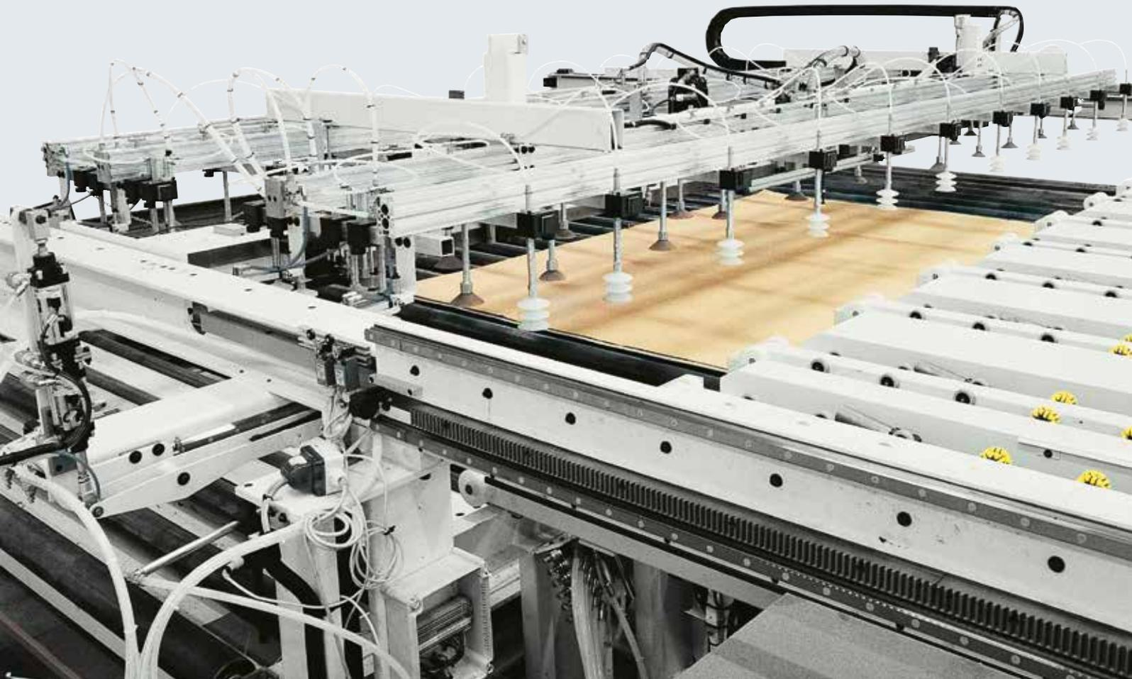
**SYSTÈME DE CHARGEMENT À VENTOUSES: LA SOLUTION IDÉALE POUR LES PANNEAUX AVEC DES REVÊTEMENTS DÉLICATS**
