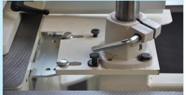
Pour brancher l'entraîneur, une fiche triphasé est prévue. L'entraîneur s'arrête avec l'arrêt d'urgence de la machine.
