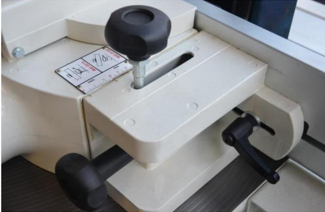
L'appareil de sécurité est attaché au dessus du guide de fraisage.
