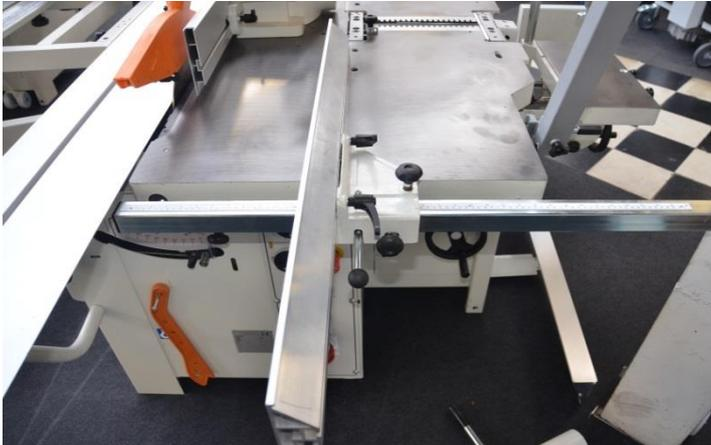
Un support en fonte tient cette règle d'arrêt fermement et maintient le guide en équerre et précisément à mesure. Contrairement à d'autres marques, cette machine à un guide individuel longitudinal et dégau. La règle d'arrêt peut être positionnée tant à l'avant qu'à l'arrière de la table de scie.
