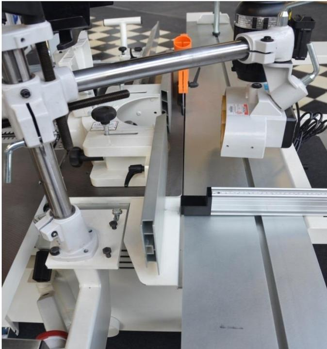
La machine peut être équipée optionnellement avec **un pied de montage** pour un entraîneur.
