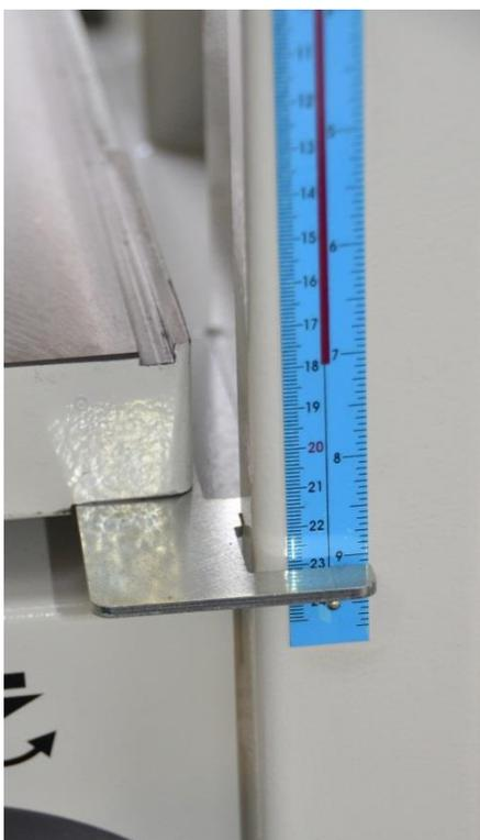
L'ouverture maximum de la table raboteuse en fonte est de 230 mm.
