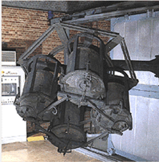
Beeld van een rotatiearm met vier matrijzen op een carrouselmachine.
